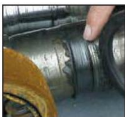
Повреждение вала от манжетного уплотнения
